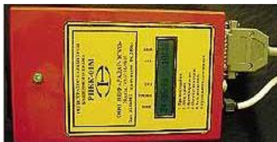
2.6 – Сурет - РПБК-01М мұнаралы кран параметрлерінің жаңғыртылған тіркеушісі
